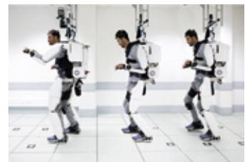
Este exoesqueleto é controlado através de eléctrodos que são colocados na cabeça do paciente, para captar as intenções de movimento de quem o está a utilizar.
